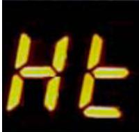
Сообщение «Ht» высвечивается при перегреве нагревательного элемента
