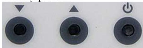
Регуляторы температуры: Кнопками ▲, ▼ выставите желаемую температуру нагрева. После выставления температуры, терморегулятор с задержкой в 3 секунды автоматически переходит в режим показа реальной температуры нагревательного элемента.
