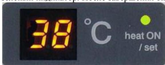
Температура: При включении ТРВ на дисплее показывается настоящая температура в области температурного датчика. Используя кнопки ▲, ▼ можно задать необходимую температуру. В процессе корректировки загорается зеленый индикатор.
