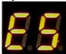
При коротком замыкании сенсора подача электричества на ТРВ прекращается, на индикаторе высвечивается сообщение об ошибке “ES”
